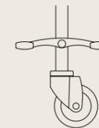
roues de Ø 125 mm, freinage central avec roue directionnelle (\*)
